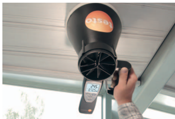
testo 417, monitoraggio dell'ingresso di aria in una bocchetta
